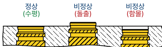
인서트의 상단은 플라스틱의 표면과 최대한 수평으로 설치되어야 합니다.
